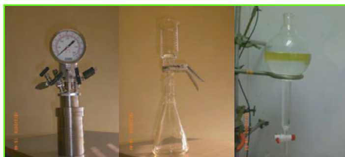
Figure 5 - Simplicité des appareillages utilisés : réaction en autoclave, filtration du catalyseur et séparation des produits.
