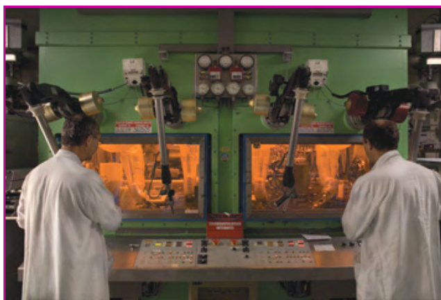
Figure 4 - Cellules chaudes de l'installation Atalante à Marcoule. © A. Gonin/CEA.
