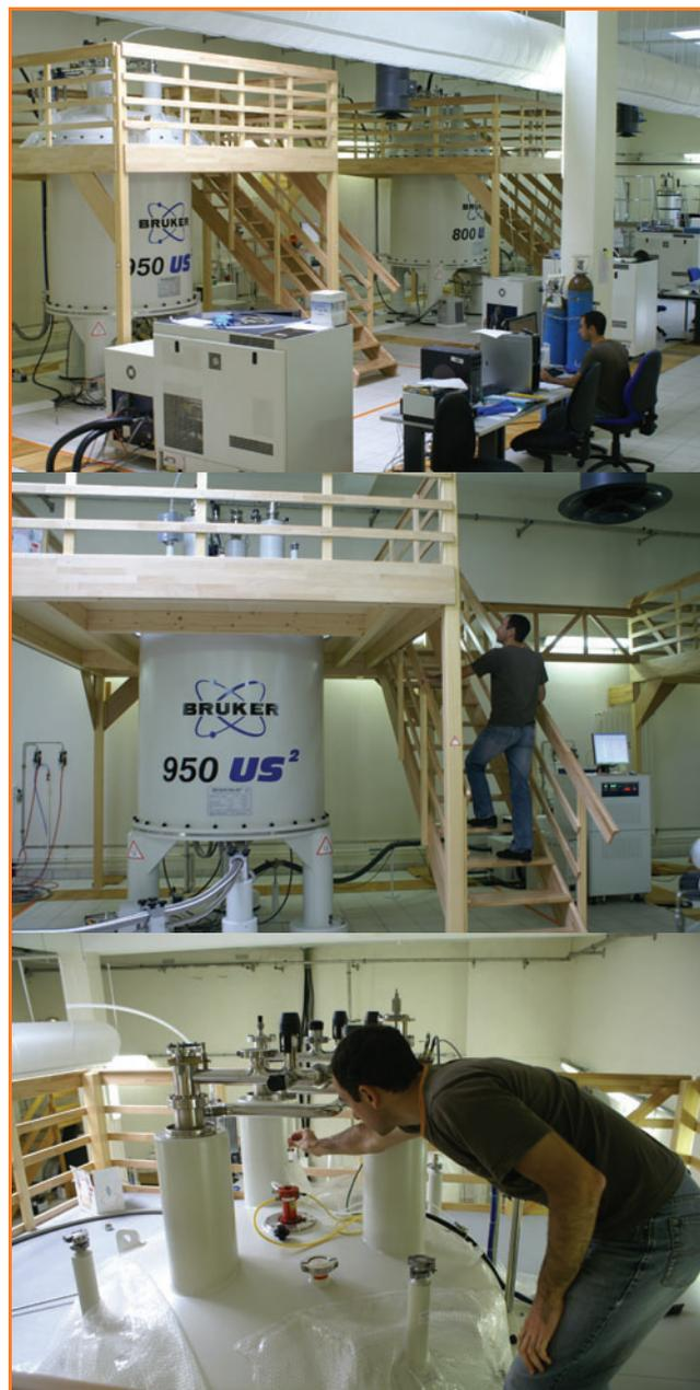
Figure 2 - En haut : trois des quatre spectromètres du Laboratoire de chimie et biochimie structurales de l'Institut de chimie des substances naturelles (ICSN, UPR 2301 du CNRS) : le 950 MHz, le 800 MHz et, au fond, le 500 MHz. Au milieu et en bas : le 950 MHz vu de face et de dessus.
