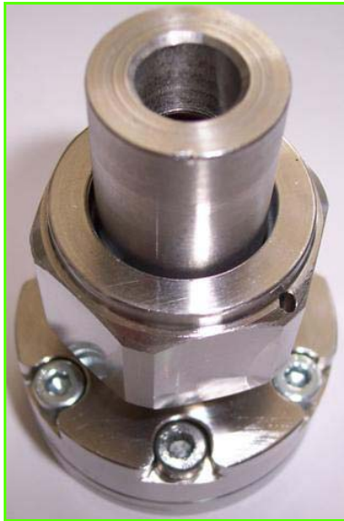
Figure 3 - La cellule électrochimique permet des mesures operando par transmission et réflexion des rayons X.
