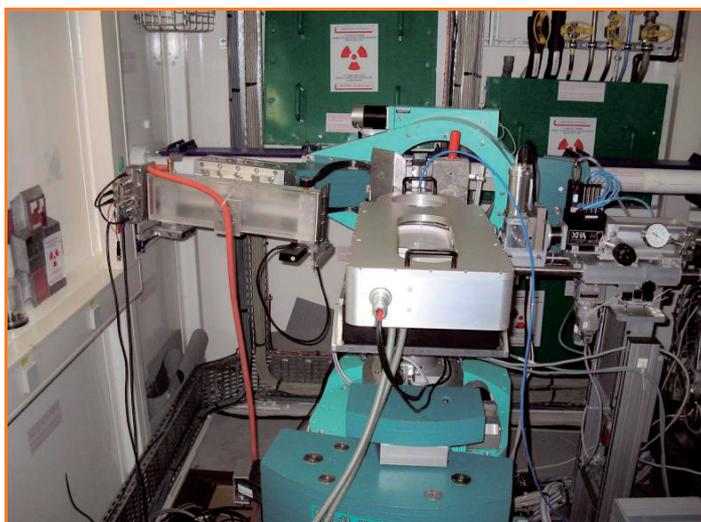
Figure 3 - Dispositif expérimental de mesure de GISAXS sur monocouche de Langmuir (donc sur surface liquide) installé sur la ligne ID10B de l'ESRF à Grenoble.
