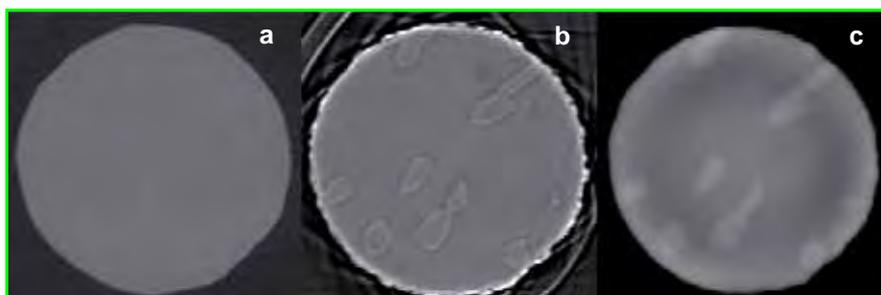
Figure 1 - Reconstruction tomographique d'un même échantillon d'acier austéno-ferritique à différentes distances  $D$  entre échantillon et détecteur : a) contraste d'absorption ( $D = 6$  mm) ; b) contraste de phase ( $D = 270$  mm) ; c) holotomographie (combinaison de quatre distances  $D = 6, 48, 94$  et  $270$  mm).
