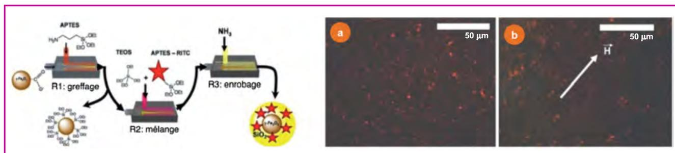
Figure 6 - Schéma illustrant le principe de couplage de plusieurs microréacteurs à flux coaxiaux, chacun ayant une fonction définie. À droite : images de fluorescence des nanoparticules synthétisées en absence de champ magnétique (a) et en présence d'un champ magnétique dont la direction est orientée suivant la flèche (b).
