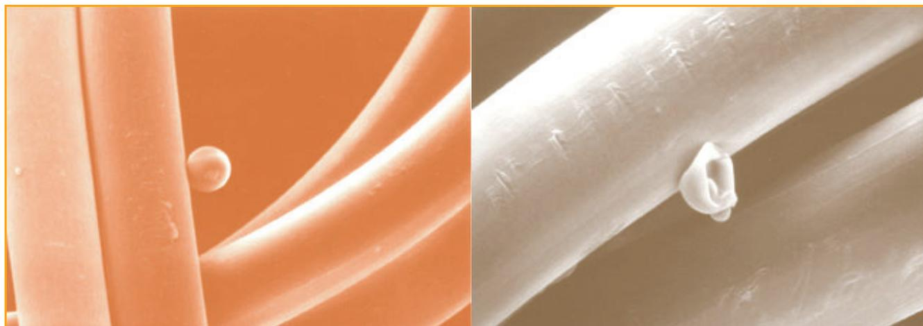
Figure 2 - Microcapsule pleine (à gauche) et vide (à droite) fixée sur une fibre textile.
