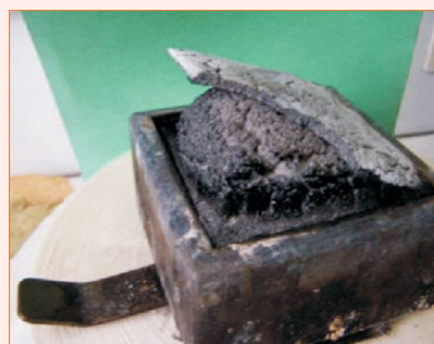
Résidu intumescent d'un matériau soumis au cône calorimètre (voir encadré 2).
