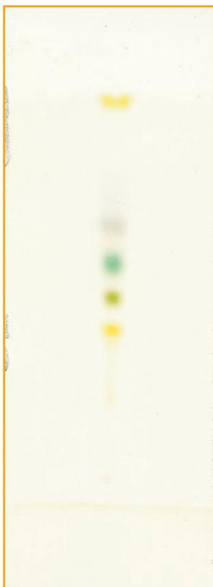
Figure 2 - Résultat d'une chromatographie sur couche mince, à partir de haricot vert broyé avec de l'acétone (le broyat est filtré, séché au sulfate de calcium, puis centrifugé).
