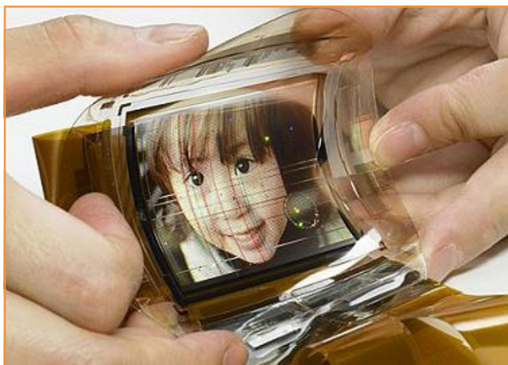
Figure 1 - Écran plat souple réalisé à l'aide de la technologie OLED (© Athowon, Desire (2008) - « Sony Working on Bendable, Folding OLED Screens »).
