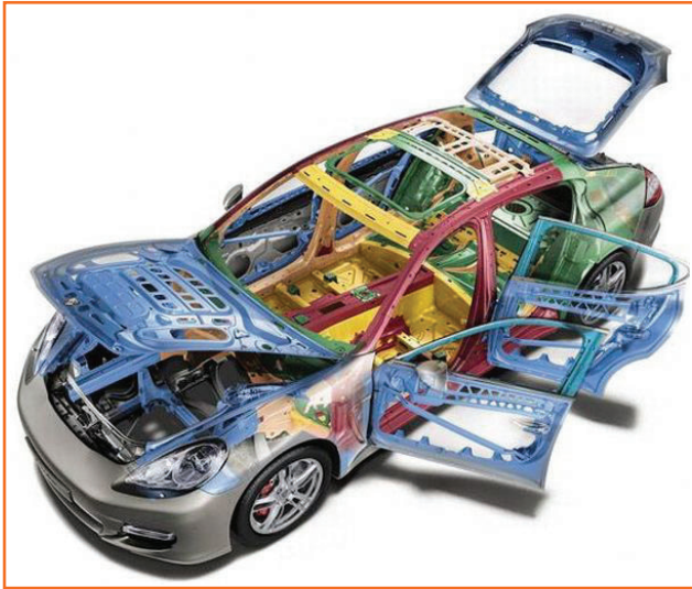
Les nuances d'aciers qui composent la structure de la Porsche Panamera (© Motor Trend).
