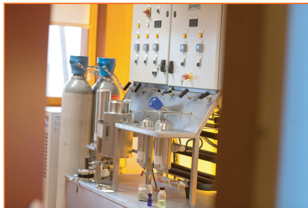
Figure 2 - Pilote d'extraction par \text{CO}_2 sc de substances naturelles à l'IFS (photo Chapuis, DR).
