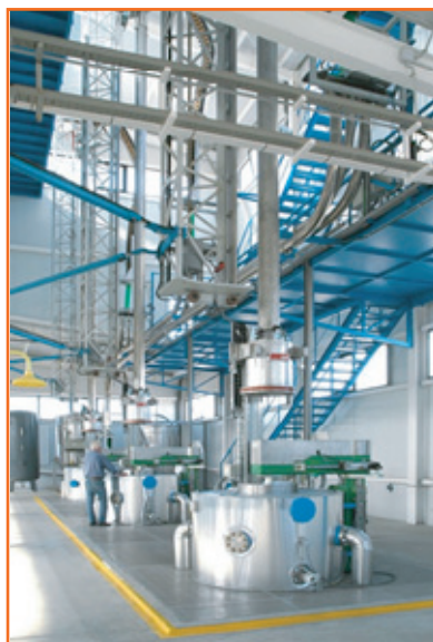
Figure 3 - Unités d'extraction par CO 2 sc d'Oneo Bouchage.
