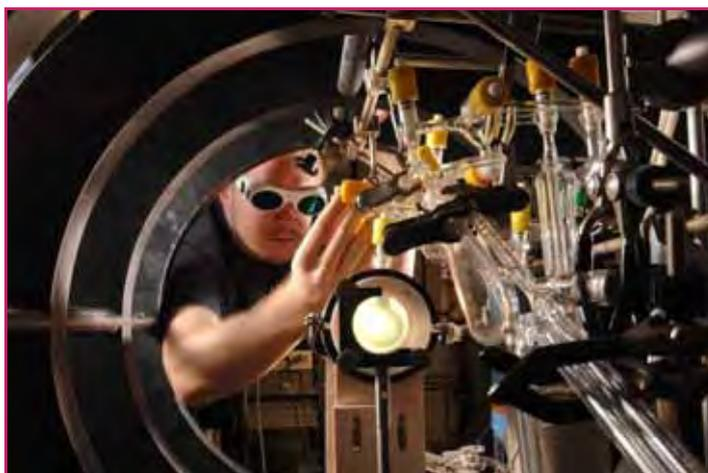
Figure 5 - Hyperpolariseur de xénon par pompage optique.
