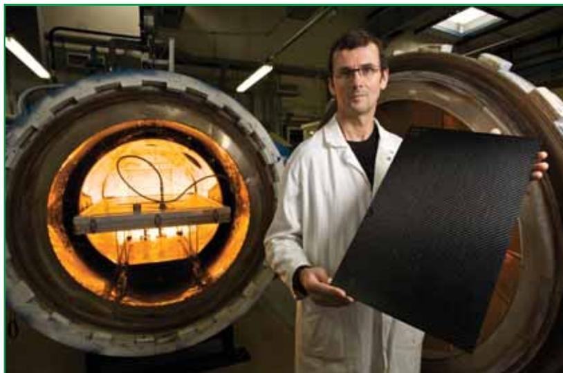
Autoclave dans laquelle sont fabriquées des plaques composites résines époxy et fibres de carbone, et contenant des nanotubes de carbone (NTC). Les NTC servent alors de renfort mécanique et permettent de dissiper les charges électrostatiques. Ces matériaux composites sont très prisés dans le secteur de l'aéronautique.
