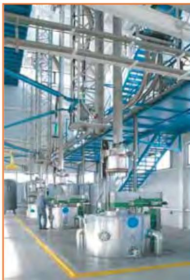
Figure 3 - Unités d'extraction par CO<sub>2</sub> sc d'Oneo Bouchage.
