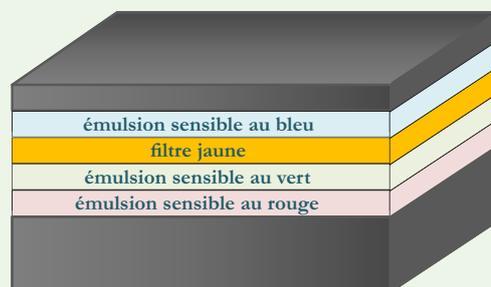
La pellicule *Kodachrome* est obtenue en superposant une émulsion sensible au bleu, un filtre jaune (laissant passer le rouge et le vert), une émulsion sensible au vert, et une émulsion sensible au rouge [a].
