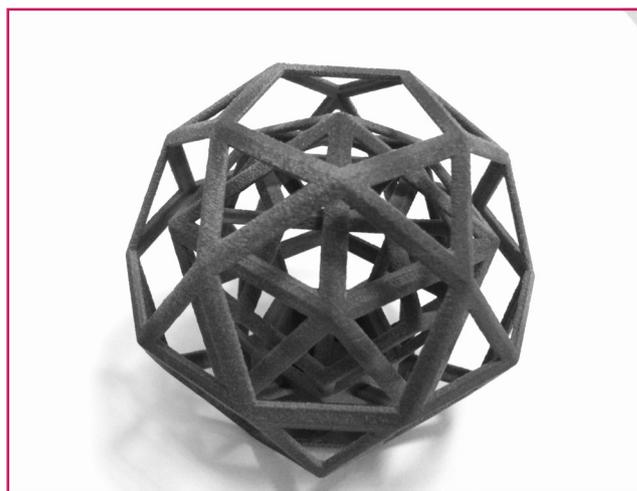
Figure 1 - Pièce à base d'alliage métallique complexe fabriquée par frittage laser sélectif.
