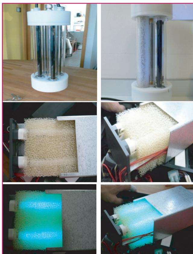
Figure 12 - Prototypes de géométrie variable conçus au LMSCP et intégrant des médias photocatalytiques  $\text{TiO}_2$ /mousses alvéolaires structurées en PU passivées, pour la dépollution chimique et la décontamination biologique de l'air en environnement indoor (2 ou 4 lampes UV-A selon les configurations).
