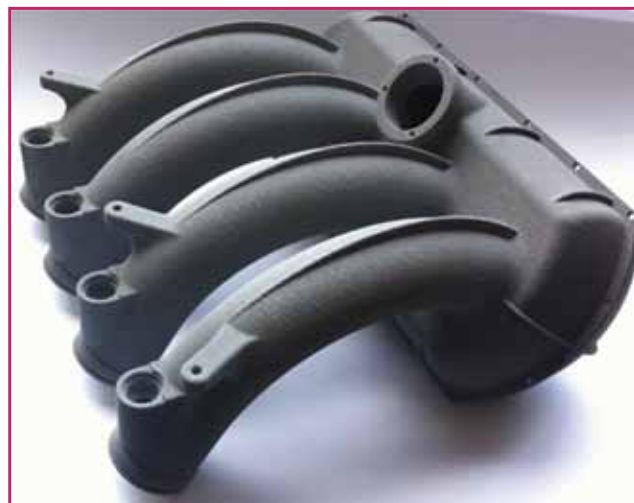
Figure 10 - Répartiteur d'admission d'air directement fonctionnel après fabrication SLS (avec la permission des Ateliers CINI et MV2T, DR).
