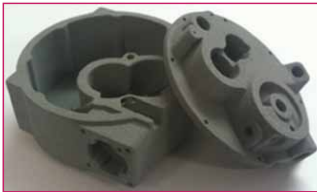
Figure 3 - Exemples de préformes contenant une poudre quasicristalline et un liant polymère.
