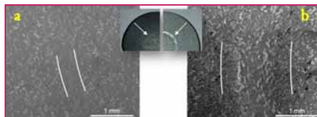
Figure 6 - Trace de frottement observée (a) après 100 m sur un composite renforcé par des particules de CMA, et (b) après 60 m de frottement sur un composite renforcé par des particules d'aluminium cristallin.
