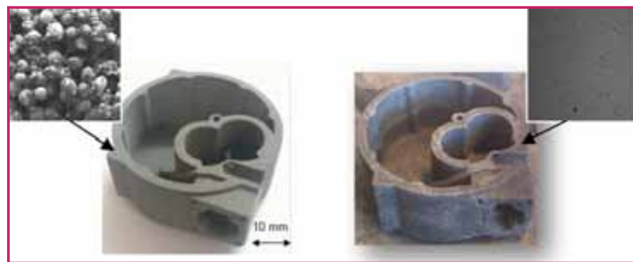
Figure 4 - À gauche : préforme obtenue par SLS. À droite : pièce infiltrée sous vide par un alliage Al-1050.
