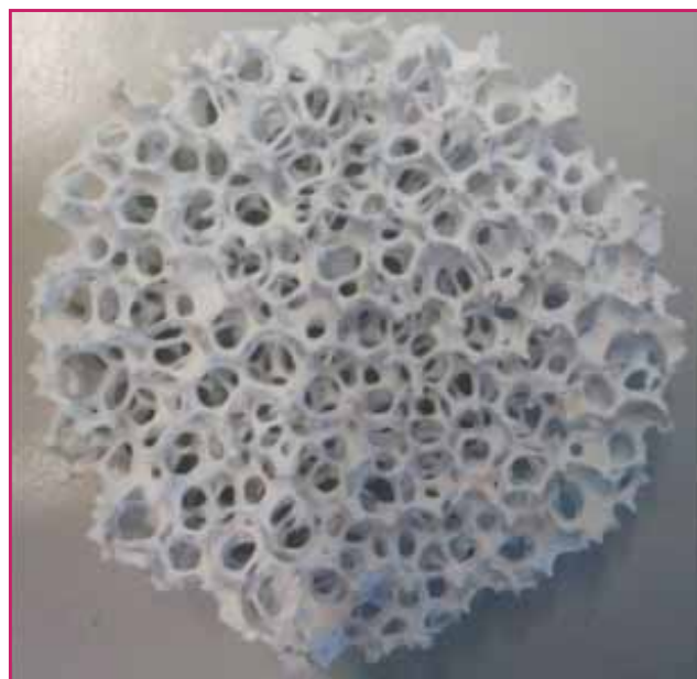
Figure 1 - Média photocatalytique constitué d'une mousse alvéolaire structurée recouverte d'un dépôt de nanoparticules de \text{TiO}_2 .
