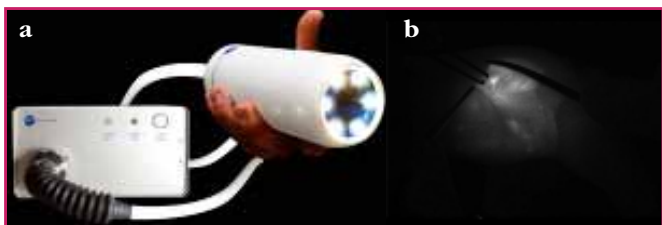
Figure 10 - (a) Présentation de la sonde : l'instrument est constitué d'un boîtier de contrôle et d'une tête (caméra et éclairage) reliés au boîtier par un câble pouvant être déconnecté. Le système est relié à un ordinateur par une connexion USB2. (b) Exemple de nodule de petite taille détecté par le couple AngioStamp™-Fluobeam™.
