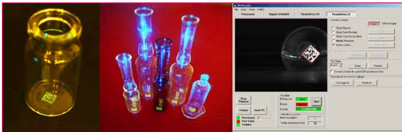
Figure 14 - Prototype de DataMatrix en cours de développement par Athéor sur différents supports en verre (flacons, bouteilles, ampoules...). Le marquage est détecté et lu par le lecteur Glass'Reader développé par Athéor.
