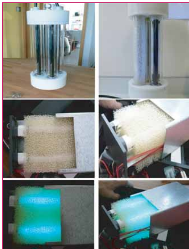
Figure 12 - Prototypes de géométrie variable conçus au LMSPC et intégrant des médias photocatalytiques TiO 2 /mousses alvéolaires structurées en PU passivées, pour la dépollution chimique et la décontamination biologique de l'air en environnement indoor (2 ou 4 lampes UV-A selon les configurations).
