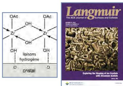
Représentation schématique de l'interaction entre l'acétate de zirconium et la surface de la glace en croissance. L'adsorption en surface par les liaisons hydrogène freine l'incorporation de nouvelles molécules d'eau en surface du cristal et conduit éventuellement à une croissance facettée. Si l'adsorption n'est que partielle, les cristaux croissent selon un spirale (comme on l'observe sur la photo de couverture de *Langmuir*). © S. Deville.
