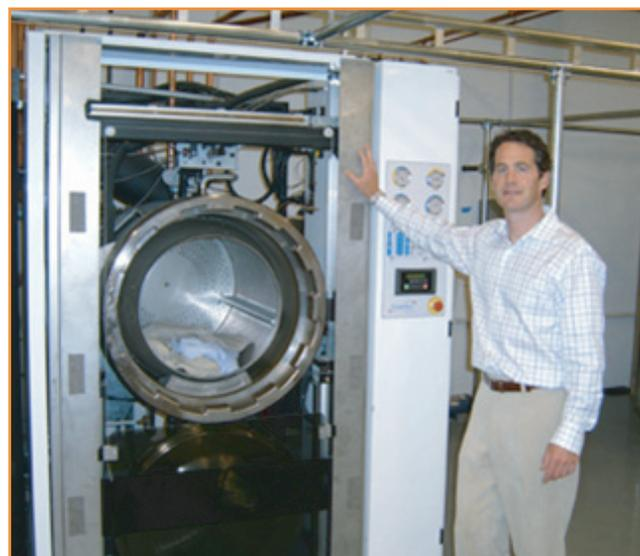
Figure 6 - Cabine de nettoyage à sec de textiles par CO<sub>2</sub> SC aux États-Unis.
