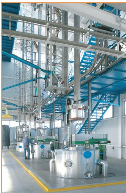
Figure 3 - Unités d'extraction par CO<sub>2</sub> SC de Diam Bouchage.
