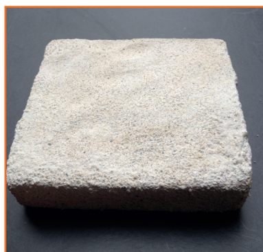
Figure 2 - Élément (4 x 16 x 16 cm) de béton décarboné.
