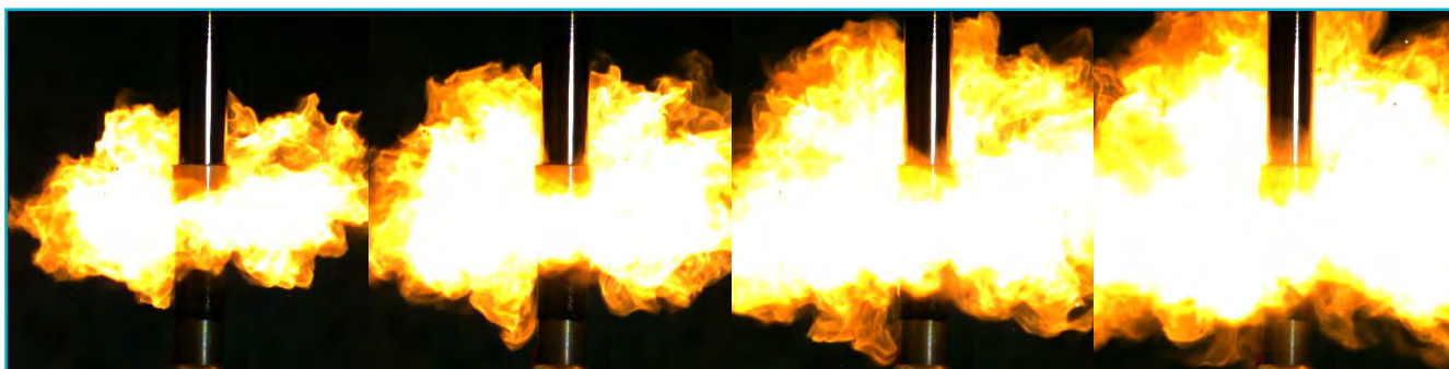
Combustion d'une nanothermite génératrice de gaz à base de trioxyde de tungstène et d'aluminium (ISL, DR).
