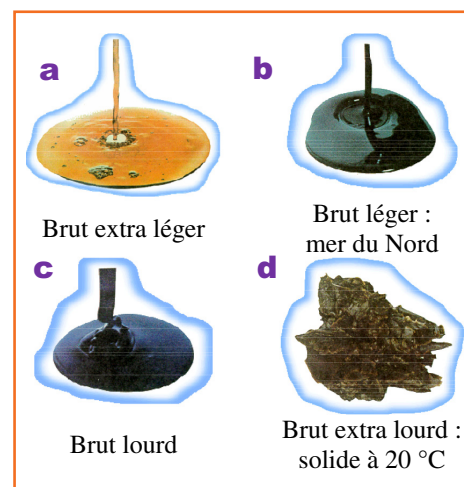
Figure 1 - Illustration de l'aspect et des propriétés d'écoulement des bruts.
