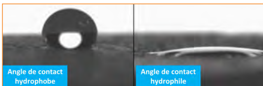
Figure 5 - Expérience de mouillage de surfaces hydrophobe et hydrophile par une goutte d'eau.
