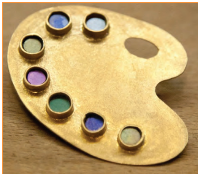
Figure 2 - Réalisation d'un bijou par les étudiants de la licence professionnelle « Traitements de surface et de gestion environnementale » de Besançon. Palette avec dépôt d'or + couleur en titane anodisé.
