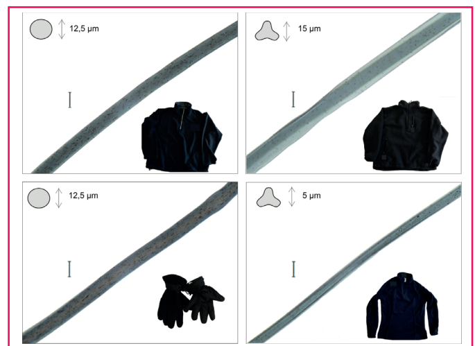
Figure 5 - Photographies des fibres composant les quatre références en matière polaire noire (grossissement 800 x), saisies sur plusieurs suspects.
