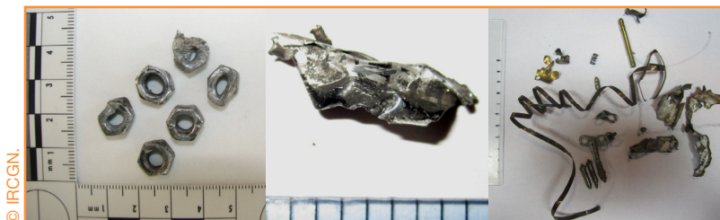
Figure 3 - Fragments métalliques déformés par les effets d'une explosion..
