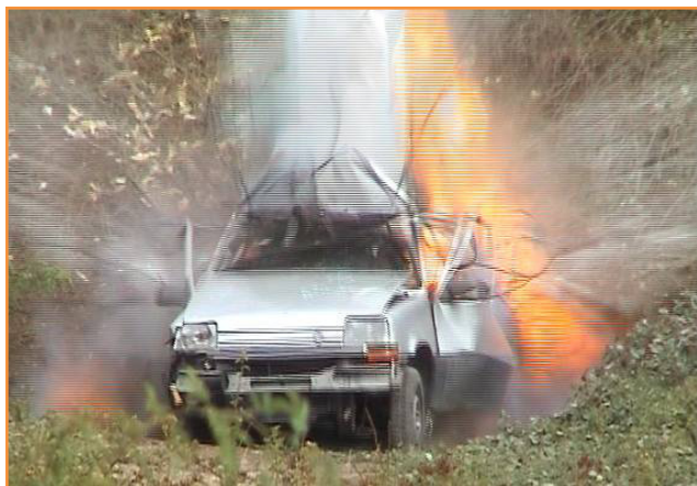
Figure1 - Explosion d'une charge explosive dans un véhicule.
