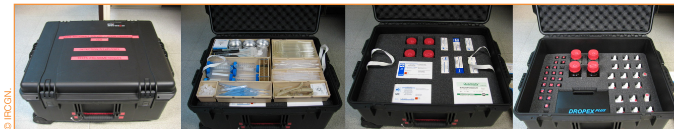
Figure 4 - Mallette colorimétrique développée au sein de l'IRCGN comprenant à la fois des tests colorimétriques commerciaux et des tests colorimétriques à façon.
