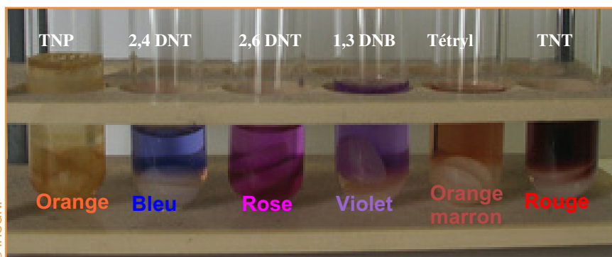
Figure 5 - Mise en évidence des explosifs de type nitroaromatiques (TNP, 2,4 DNT, 2,6 DNT, 1,3 DNB, tétryl et TNT).
