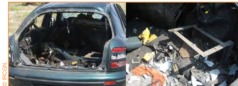
Figure 2 - Vues générale et rapprochée de l'intérieur d'un coffre après explosion d'une charge explosive dans un véhicule..
