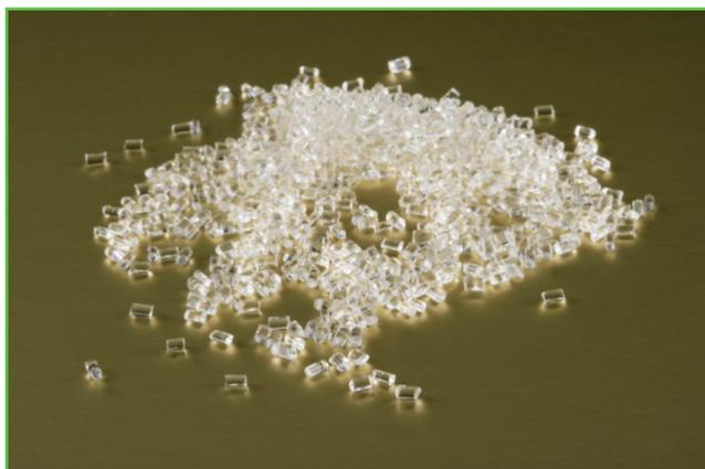
Figure 4 - Pellets d'acide polylactique produits à Escanaffles (Belgique).
