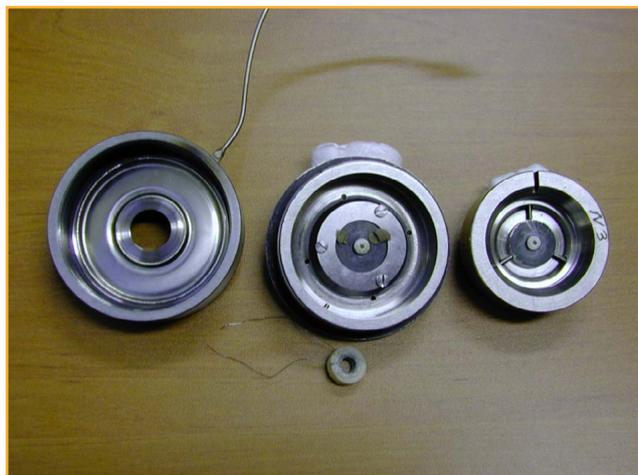
Figure 2 - Cellule à enclumes de diamant chauffante (diamètre 60 mm). Le petit cylindre gris en dessous de la cellule est le four placé autour des diamants. C'est la membrane déformable (à gauche) qui permet d'appliquer la force sur le piston.
