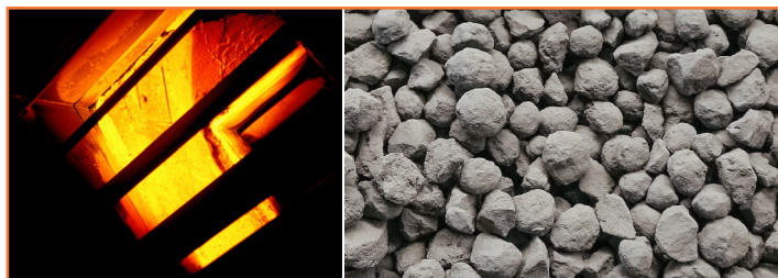
Figure 3 - Matière en fusion dans le four rotatif (1 500 °C) et nœuds de clinkers refroidis.
