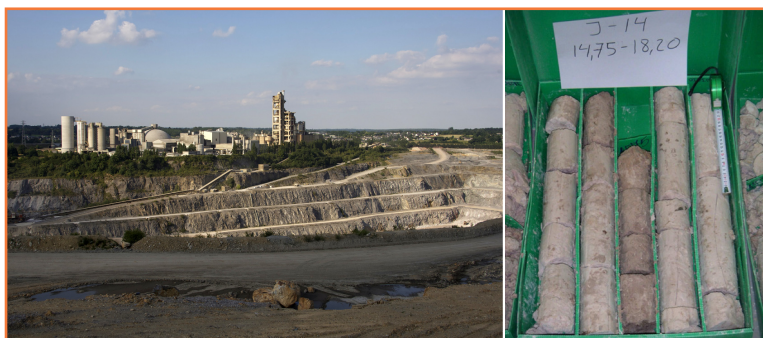
Figure 1 - À gauche : vue d'une carrière en exploitation et cimenterie en arrière-plan (les carrières ne sont pas toujours aussi proches de la cimenterie et nécessitent parfois l'installation de convoyeurs quelquefois long de plusieurs kilomètres !). À droite : exemple de carottes prélevées lors d'une identification de carrière.
