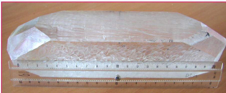
Figure 8 - Cristal de quartz de grande taille et de haute qualité élaboré par synthèse hydrothermale. On peut distinguer sur la face avant de nombreux dômes de croissance, chacun correspondant à l'émergence d'une dislocation vis, source de marches de croissance.
