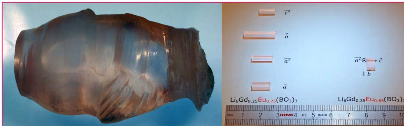
Figure 5 - Cristaux massifs, brut de croissance (à gauche) et mis en forme orientée (à droite), de  $\text{Li}_6(\text{Eu,Gd})(\text{BO}_3)_3$ , élaborés par une combinaison des méthodes Czochralski et Kyropoulos pour des applications en bolométrie à chaleur-scintillation ou pour la recherche de nouvelles sources lasers rouge/orange.
