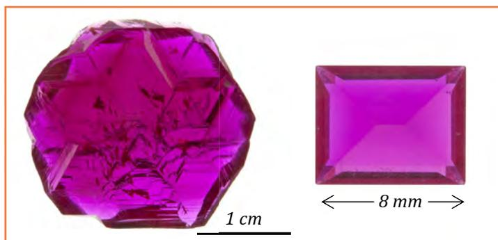
Figure 7 - Rubis obtenu par dissolution anhydre par Ramaura (États-Unis) (à gauche) et par le procédé de tirage ou Czochralski (États-Unis) (à droite).
