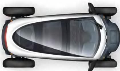
Twizy, la voiture électrique de Renault, dont le toit transparent est en PMMA nanostructuré Altuglas<sup>®</sup>ShieldUp.
