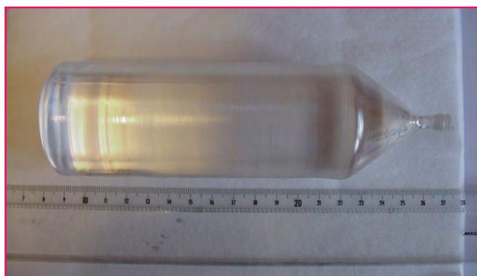
Figure 1 - Cristal de 1,7 kg de TeO<sub>2</sub> élaboré par la méthode de Czochralski.
