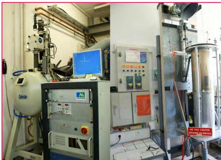
Figure 6 - Fours de tirage Czochralski (à gauche) et Bridgman-Stockbarger (à droite). Ces deux types d'appareils, les plus répandus dans l'industrie, permettent d'élaborer à quelques mm/h des cristaux de plusieurs centaines de grammes de très haute pureté. Le four Czochralski peut atteindre une température de 1 500 °C grâce à un chauffage inductif, tandis que le four Bridgman peut atteindre 1 300 °C grâce à un chauffage résistif.
