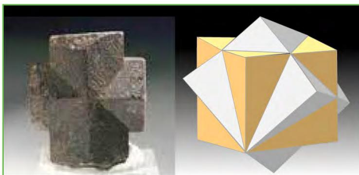
Figure 8 - Différents types simples de macle dans un cristal cubique : à gauche, dans la staurotide (un aluminosilicate de fer), les deux cubes sont maclés à 90° ; la figure de droite montre un maillage des deux cubes à 60°, rencontré fréquemment dans la pyrite FeS<sub>2</sub>.
