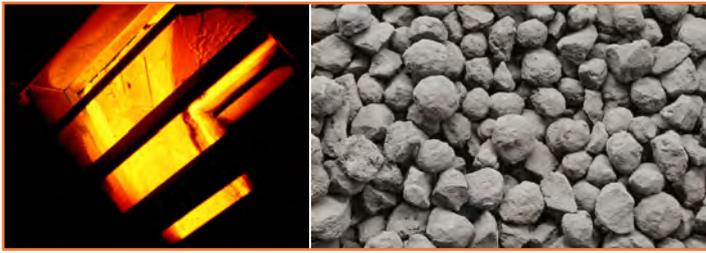
Figure 3 - Matière en fusion dans le four rotatif (1 500 °C) et nodules de clinkers refroidis.
