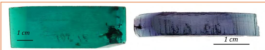
Figure 5 - Émeraude et saphir de synthèse hydrothermale (fabrication russe, Novossibirsk).
