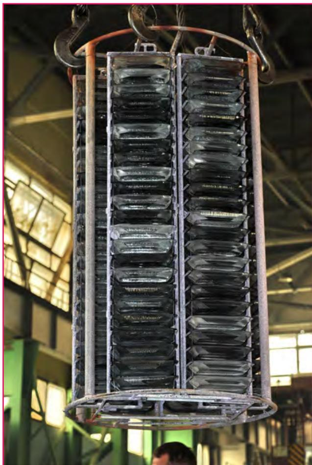
Figure 7 - 1 400 cristaux (2 300 kg) de quartz  $\alpha$  ( $\alpha$ -SiO<sub>2</sub>) obtenus en croissance hydrothermale dans un autoclave industriel (dimensions internes : 65 cm de diamètre pour 14 m de long). On devine le sommet de la tête de l'opérateur en bas de l'image.
