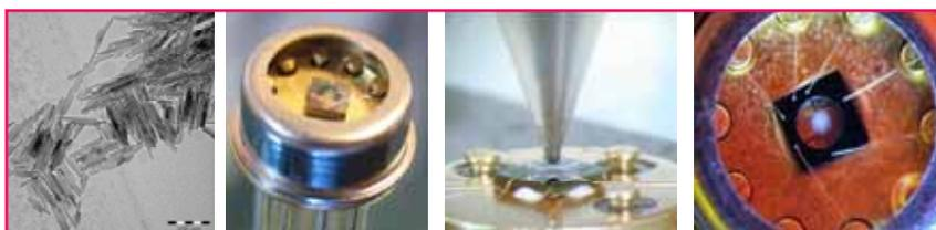
De gauche à droite : image par microscopie électronique à transmission de nanobâtonnets de ZnO, plateforme de silicium, intégration des NP sur la plateforme par jet d'encre et capteur de gaz prêt à fonctionner.
