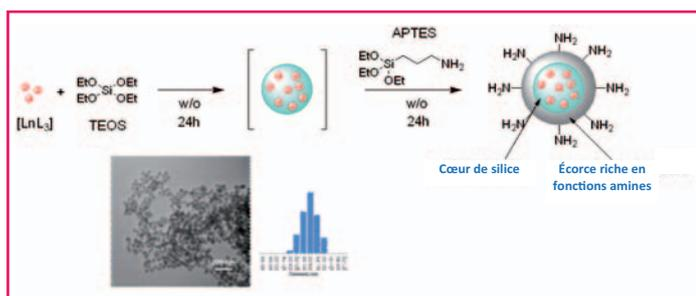
Figure 5 - Synthèse de nanoparticules (NP) de silice fonctionnalisées en surface par des amines, cliché MET et distribution de diamètre des NP.
