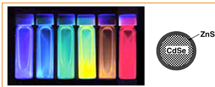
Figure 6 - Photoluminescence de nanocristaux semi-conducteurs (quantum dots) éclairés par une lampe ultraviolette. Ils sont constitués de sélénure de cadmium de différentes tailles allant de 1 nm (violet) à 4 nm (rouge) avec une coque protectrice en sulfure de zinc (Aldrich).
