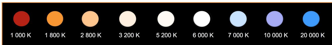
Figure 5 - La couleur d'un corps incandescent est directement liée à la température, que l'on dénomme, de ce fait, *température de couleur*. Il s'agit d'une température absolue exprimée en kelvins (K).
