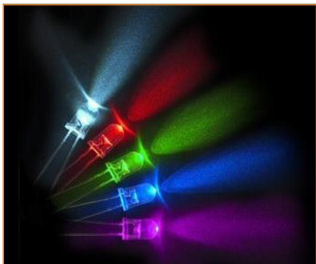
Figure 7 - Les LED produisent des lumières colorées qui dépendent de la nature du semi-conducteur ([www.minioneon.com](http://www.minioneon.com)).
