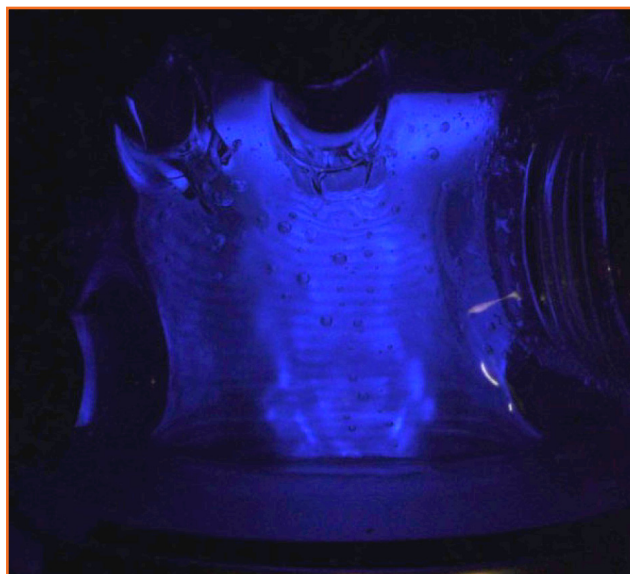
Figure 2 - Photographie dans l'obscurité d'un réacteur de sonochimie contenant une solution de luminol (5-amino-2,3-dihydro-1,4-phthalazinedione) sous irradiation ultrasonore (362 kHz, 43 W, Ar, 20 °C).
