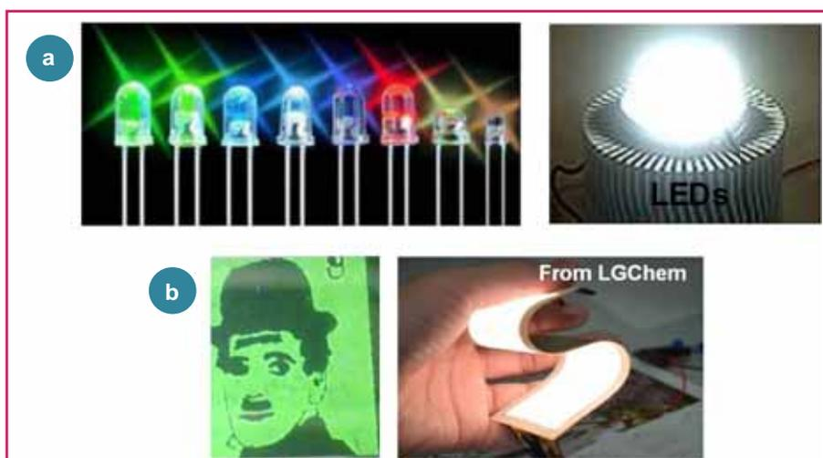
Figure 2 - Comparaison entre a) une diode électroluminescente inorganique ou LED, qui est une source ponctuelle, et b) une diode électroluminescente organique ou OLED qui est une source de lumière étendue, car toute la surface du film organique émet de la lumière (portrait de Charlot). Par ailleurs, une OLED a l'avantage de pouvoir être réalisée sur un support flexible et elle peut être relativement transparente dans l'état éteint.
