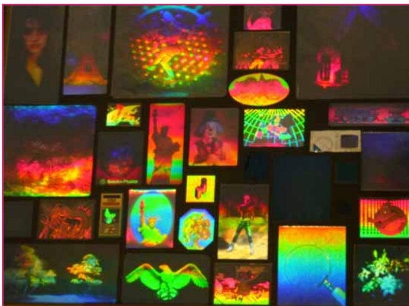
Figure 5 - Collection d'hologrammes créés par estampillage, l'hologramme maître étant enregistré dans un photoresist. Ils sont utilisés à des fins publicitaires, en tant que systèmes anti-contrefaçon ou permettent d'introduire des illustrations en trois dimensions dans les magazines (Collection C. Carré).
