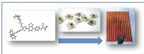
Schéma des réalisations de l'équipe de l'INAC et de ses partenaires ICIQ et Solaronix. Les chercheurs ont travaillé depuis la conception de molécules pour produire des colorants nouveaux, à la réalisation de cellules et modules photovoltaïques performants. © CEA.
