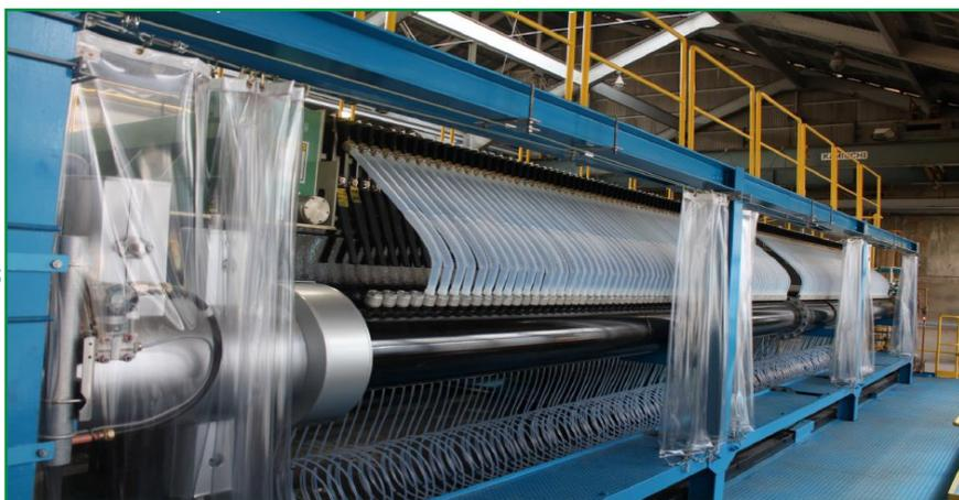
Un électrolyseur membrane.
