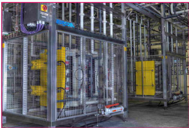
Figure 2 - Unité industrielle de déminéralisation de lactosérum par électrodialyse. © Eurodia.
