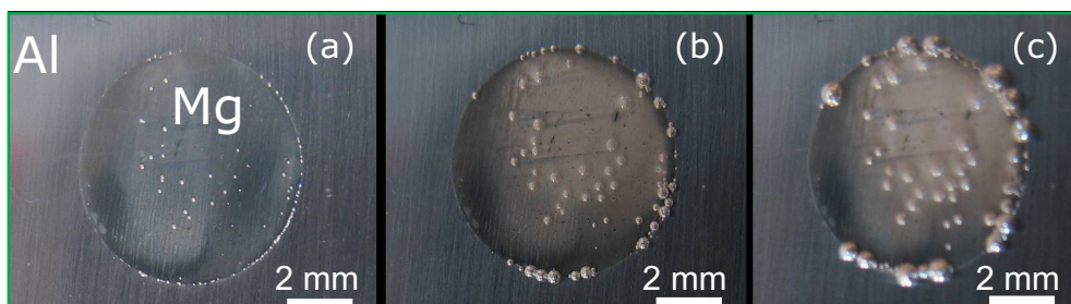
Figure 3 - Photos d'un couple magnésium (disque au centre) et aluminium (périphérie) immergé dans une solution de sulfate de sodium pour différents temps d'immersion : (a) 4 min, (b) 20 min et (c) 60 min. L'aluminium est la cathode et le magnésium est l'anode. Ces photos illustrent le dégagement de dihydrogène (NDE) lors d'une polarisation anodique d'une électrode de magnésium.
