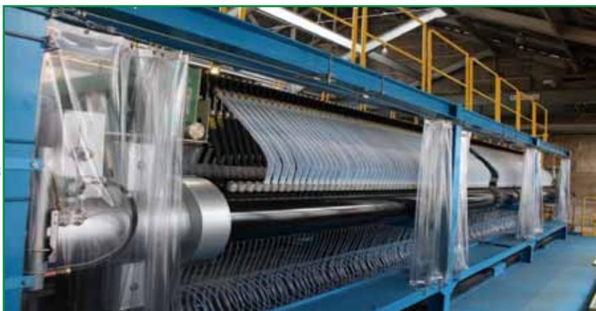
Un électrolyseur membrane.
