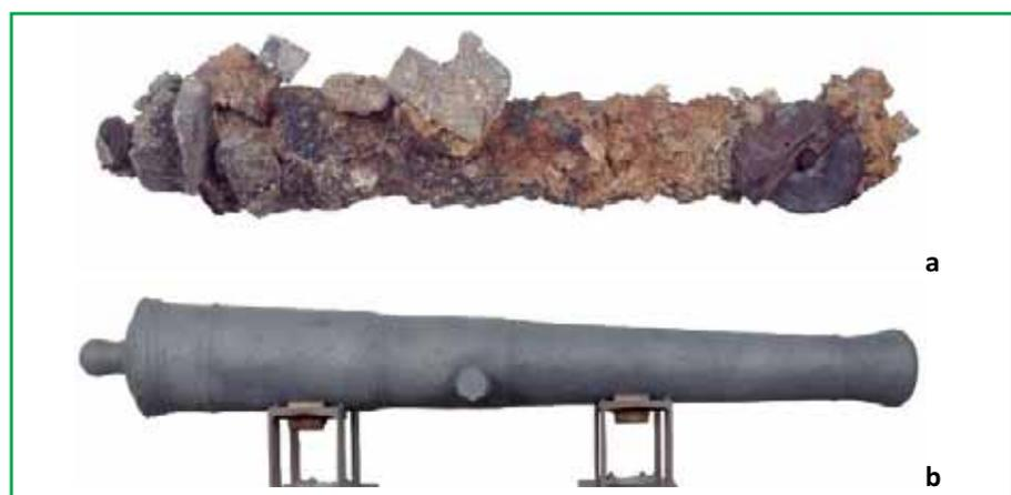
Figure 2 - Canon provenant de l'épave de l'*Alcide* datant du début du XVIII<sup>e</sup> siècle, exposé dans la ville de Carantec, avant traitement (a) et après traitement (b). Cliché J.G. Aubert, Laboratoire Arc'Antique, DR.
