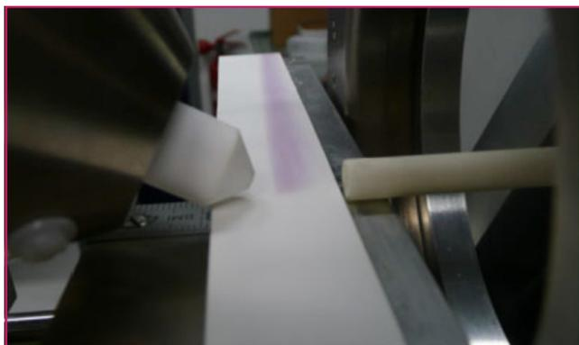
Figure 10 - Exemple d'une analyse utilisant la désorption selon un angle [25].
