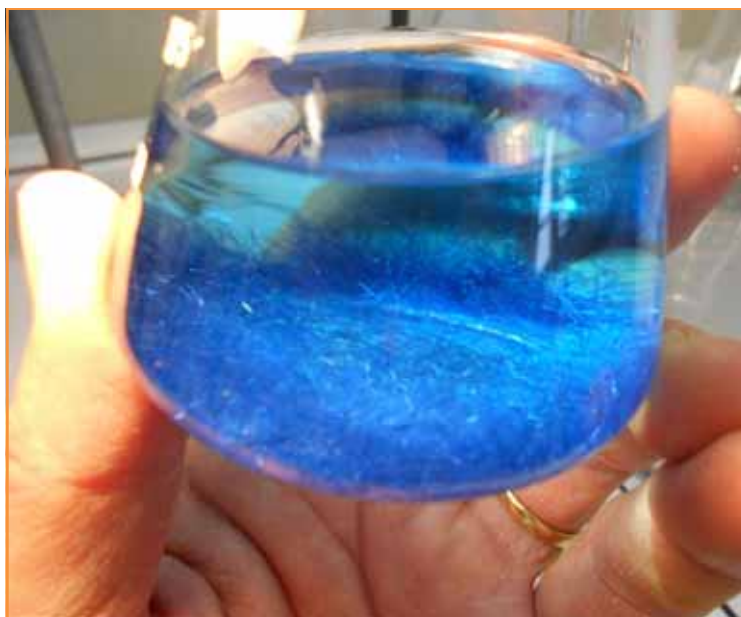
Figure 1 - Le complexe \text{Cu}(\text{Acac})_2 recrystallisé dans l'éthanol.
