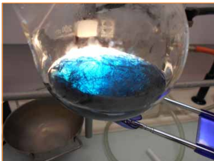
Figure 2 - La cristallisation du complexe dans le butan-1-ol observée par transparence à l'aide d'une lampe.
