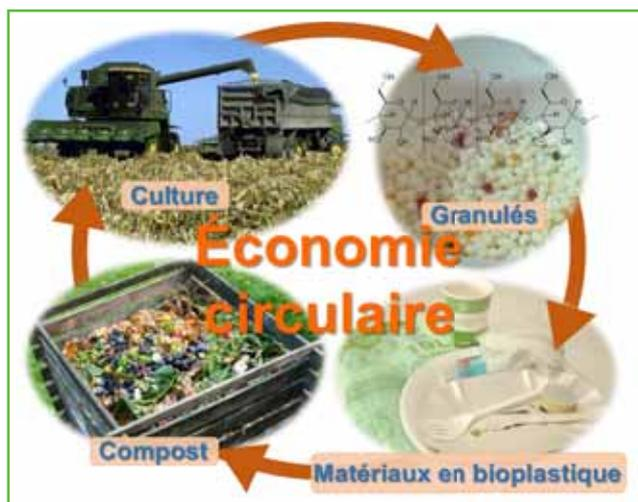
Figure 5 - Des emballages en plastique biodégradable sont fabriqués à partir de l'amidon issu de céréales ou de pommes de terre. Un traitement mécanique permet d'extraire l'amidon de la plante entière ou des grains pour le transformer chimiquement en granulés de bioplastique. Ces derniers sont transformés à chaud à l'aide de moules en bioplastique compostable dans le jardin.
