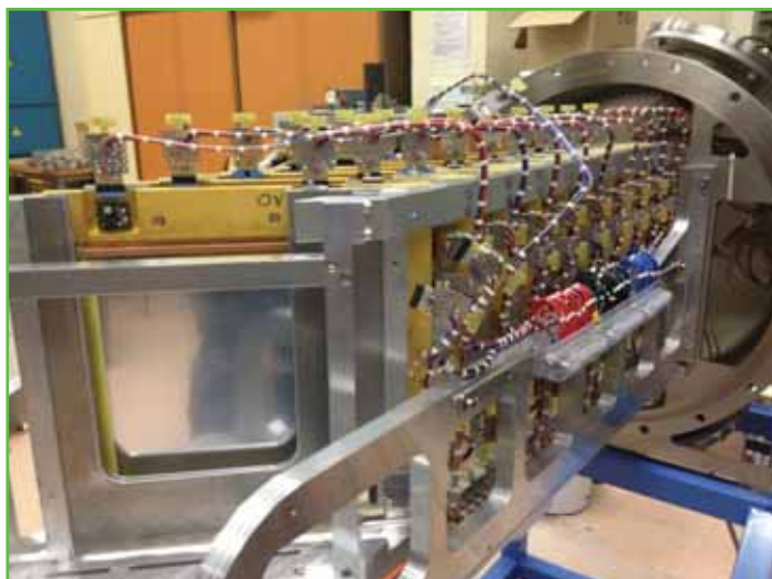
Figure 2 - Ensemble cibles-détecteurs utilisé sur la ligne n-TOF du CERN.
