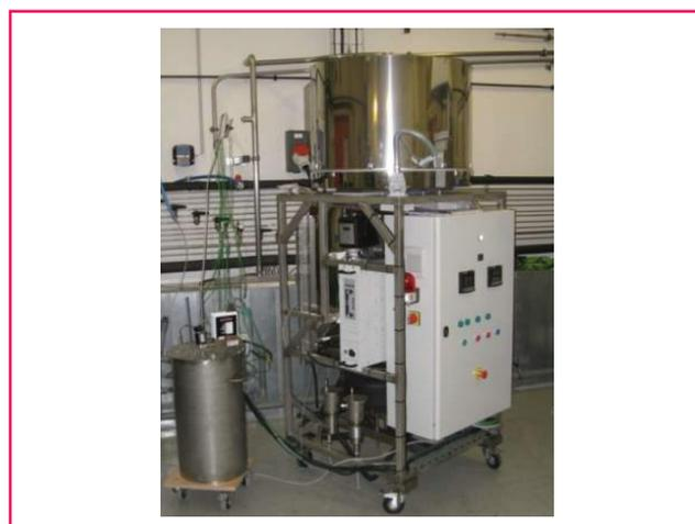
Figure 2 - Système SOEC/SOFC.
