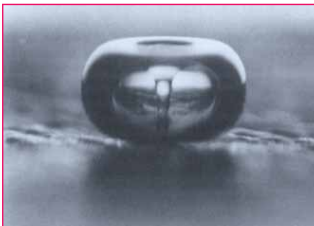
Figure 5 - Photographie du jet de liquide formé pendant l'implosion d'une bulle de cavitation. Dans cet exemple, le diamètre de la bulle est d'environ 2 mm.
