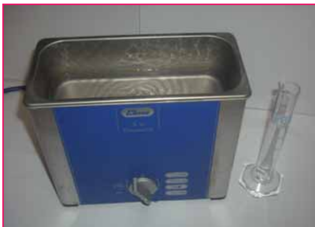
Figure 7 - Bac à ultrasons basse fréquence (ici 50 kHz) largement répandu dans les laboratoires.
