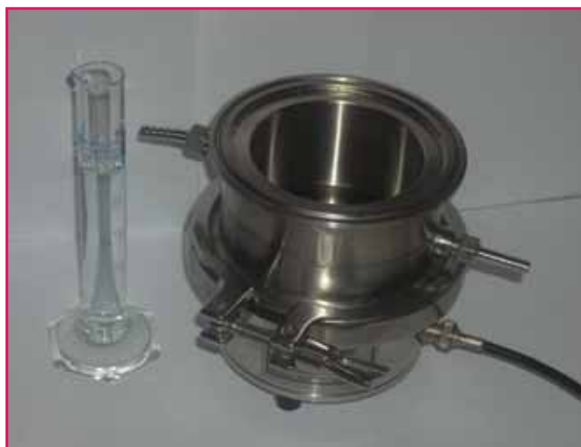
Figure 9 - Réacteur en inox de type « cup-horn » de fréquence 550 kHz équipé d'une double enveloppe permettant de réguler la température du milieu par circulation d'un liquide thermostaté.
