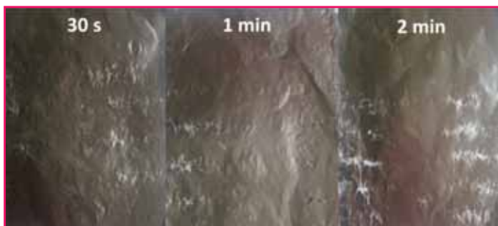
Figure 5 - Aspect d'une feuille d'aluminium plongée verticalement dans un bac à ultrasons (20 kHz) après 30 s, 1 min et 2 min d'irradiation.
