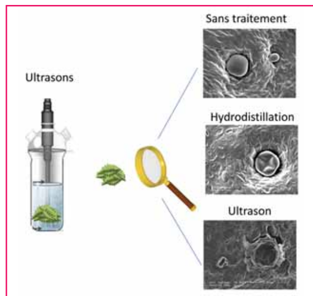
Figure 5 - Extraction des huiles essentielles de feuilles de menthe.
