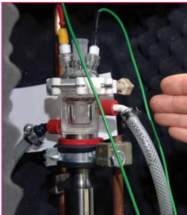
Figure 2 - Réacteur sonochimique double enveloppe pour électrochimie en milieu liquide ionique. © Georges Pannetton/ Université de Franche-Comté.
