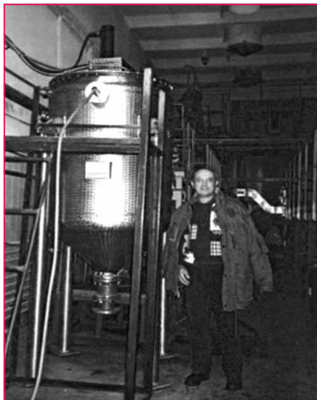
Figure 11 - Extracteur ultrasonore 1 000 L de l'entreprise Plafar, Roumanie.
