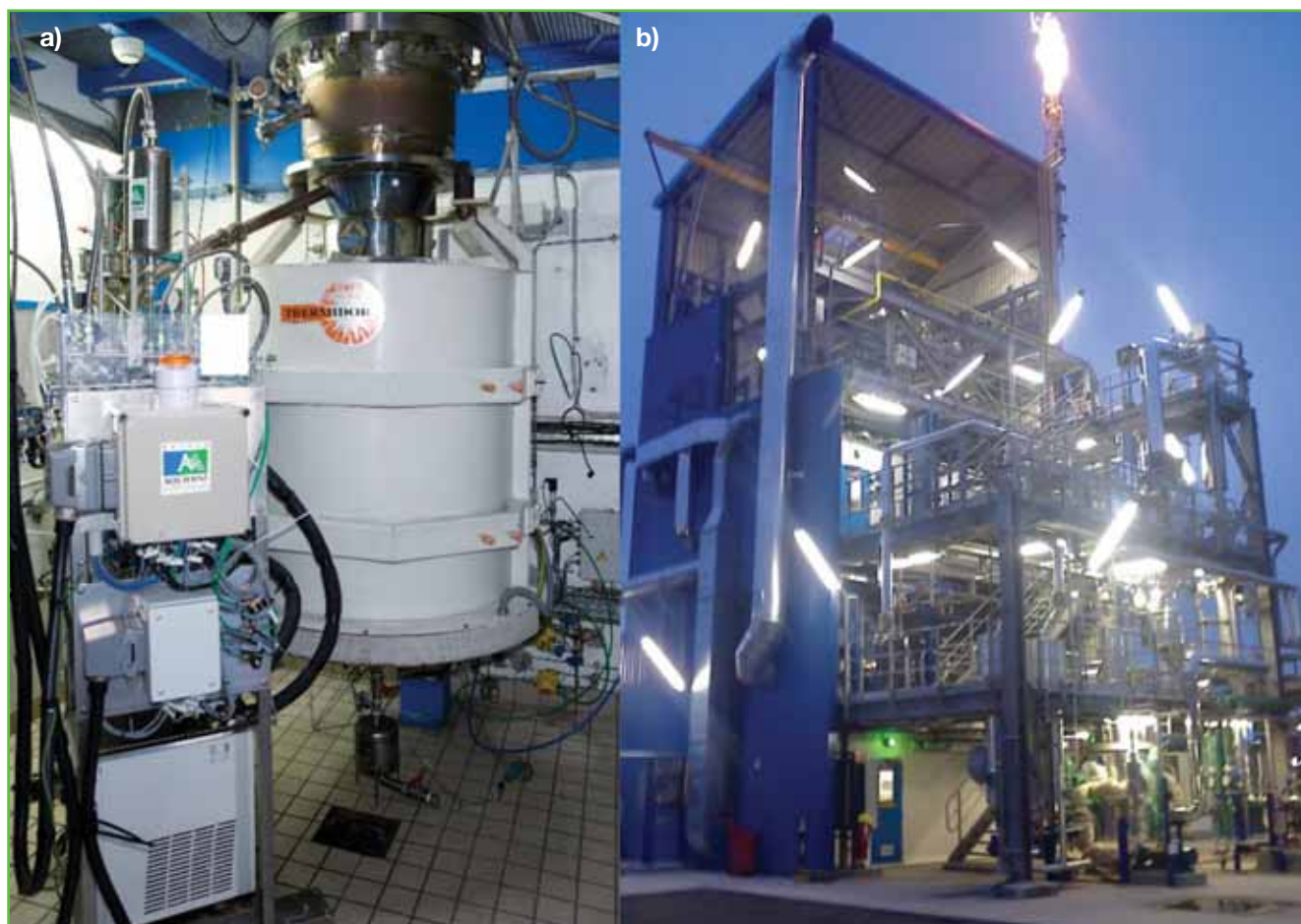
Figure 6 - a) Le pilote continu de CCVD en lit fluidisé pour la synthèse de CNT de 25 cm de diamètre, et b) l'unité industrielle Arkema de production de Graphistrength C100.
