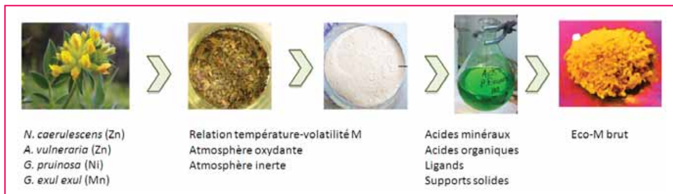
Figure 8 - Principe général de préparation d'un écocatalyseur Eco-M.
