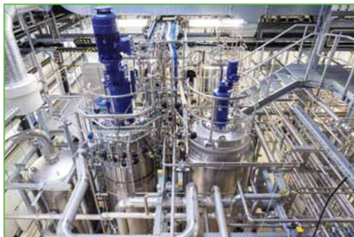
Figure 1 - Usine de démonstration de Leuna, en Allemagne. Équipée d'un bioréacteur de 5 000 L, cette installation représente la dernière étape de montée en échelle du procédé de production d'isobutène de Global Bioenergies avant l'usine commerciale. Cette dernière comprendra une série de fermenteurs de très grande taille, et demandera une nouvelle montée en échelle d'un facteur 50 environ (par fermenteur).
