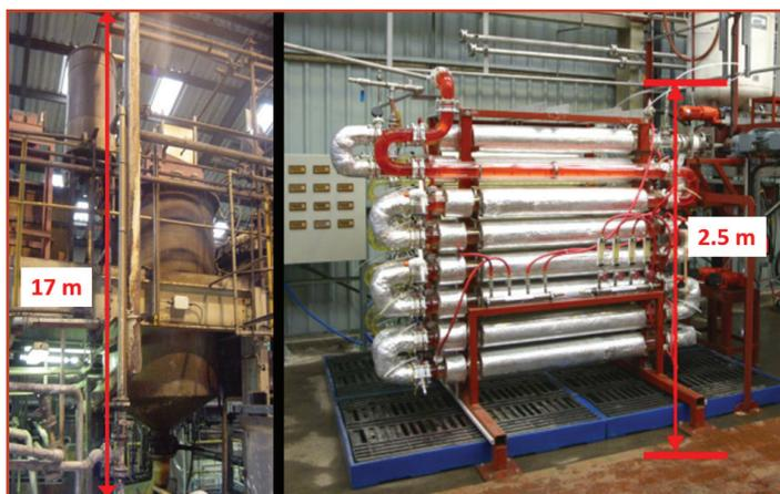
Figure 1 - Réacteur photochimique (James Robinson Ltd). Comparaison des réacteurs de même capacité : discontinu conventionnel (droite) et continu intensifié (gauche) ([www.chemspeceurope.com/content-images/main/Conferences/Continuous-Processing-to-make-better-particles\\_Ian-Laird\\_-RSC-Symposium-2011.pdf](http://www.chemspeceurope.com/content-images/main/Conferences/Continuous-Processing-to-make-better-particles_Ian-Laird_-RSC-Symposium-2011.pdf)).
