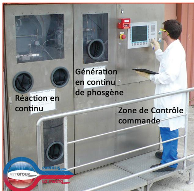
Figure 3 - Module de génération de phosgène en continu et à la demande (AET Group [18]).
