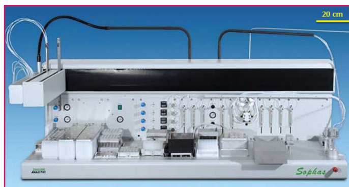
Figure 1 - Robot de synthèse chimique en parallèle (SOPHAS® Automated Synthesizer, Zinsser Analytic). Avec une capacité allant jusqu'à plusieurs milliers de composés par jour, ce type de synthétiseur est adapté au format des microplaques (96 puits) gérées par les robots de criblage. Employant aussi bien la synthèse sur support solide que la méthode classique en solution, ils permettent d'accomplir des synthèses combinatoires complexes. Ils ont ainsi contribué à réaliser de grandes collections de composés les plus divers possible dans les premiers temps. Aujourd'hui, leur utilisation est plus axée sur la création de chimiothèques de tailles plus modestes (quelques dizaines à centaines de produits de structures chimiques voisines) dans le but de contribuer aux phases d'optimisation des futurs médicaments.
