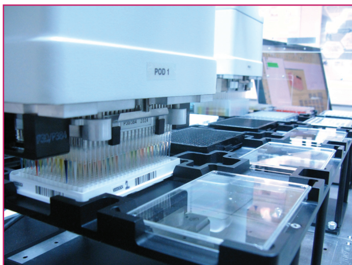
Figure 3 - Robot de pipetage Biomek FX P (Beckman Coulter) en mesure de tester 384 molécules en quelques secondes (système par aspiration de volumes de 1 à 250 \mu L). Dans les procédés de criblage, le modèle biologique est disposé dans une plaque « essai ». Les substances à tester sont prélevées dans une plaque de stockage puis mises en contact du modèle biologique. Enfin, les substrats nécessaires à l'activation du modèle biologique sont ajoutés. Après une période d'incubation, la plaque est insérée dans un lecteur permettant de vérifier l'efficacité des substances testées.
