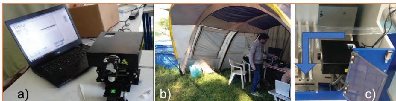
Figure 3 - Exemples d'utilisation de notre capteur pour le suivi de pollution dans des conditions difficiles (ici sous une tente (b)) et pour l'étude des propriétés de films polymères en temps réel (la flèche bleue représente le mouvement du film devant le capteur) ; dans ce second exemple, le faible encombrement de ce capteur est un atout très important.
