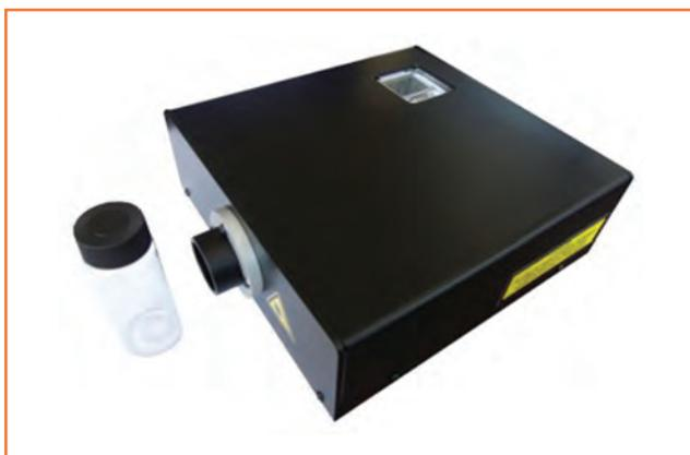
Figure 1 - Exemple d'un spectromètre expérimental « bas coût » développé par le laboratoire LMOPS permettant une mesure *in situ* et rapide ; ce capteur est compact (20 x 18 x 3 cm<sup>3</sup>).
