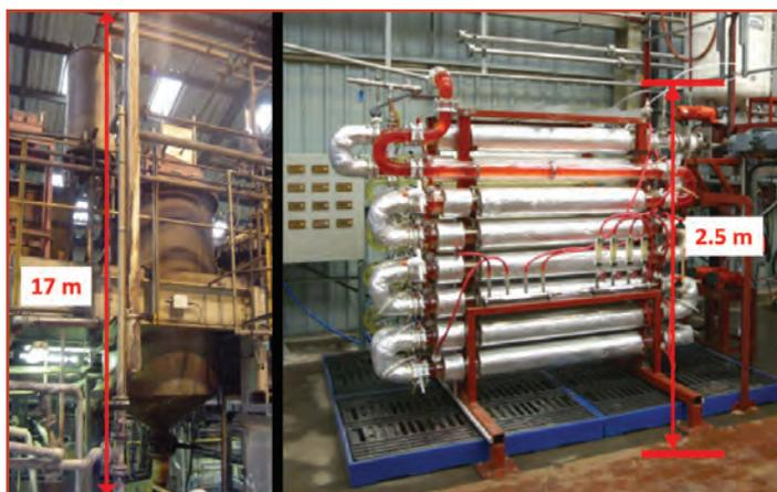
Figure 1 - Réacteur photochimique (James Robinson Ltd). Comparaison des réacteurs de même capacité : discontinu conventionnel (droite) et continu intensifié (gauche) ([www.chemspeceurope.com/content-images/main/Conferences/Continuous-Processing-to-make-better-particles\\_lan-Laird\\_RSC-Symposium-2011.pdf](http://www.chemspeceurope.com/content-images/main/Conferences/Continuous-Processing-to-make-better-particles_lan-Laird_RSC-Symposium-2011.pdf)).
